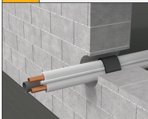
obr. 5 Klimatizační svazek ve stěně
