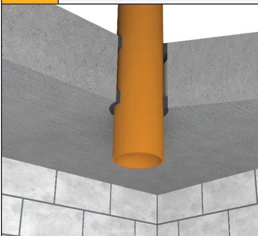
obr. 7 Těsnění prostupu hořlavého potrubí stropem o tloušťce A \geq 150 mm a objemové hmotnosti \rho \geq 550 kg/m 3
