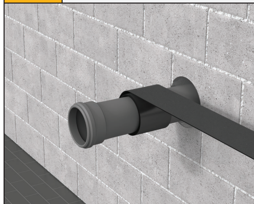
obr. 1 Prostup hořlavého potrubí stěnou
