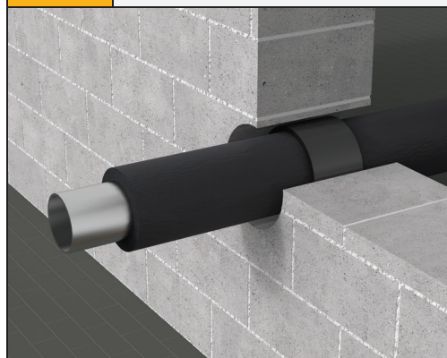
obr. 3 Kovové potrubí s průběžnou hořlavou izolací – ve stěně
