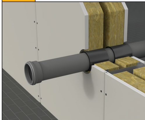
obr. 7 Těsnění hořlavého potrubí – ve stěně
